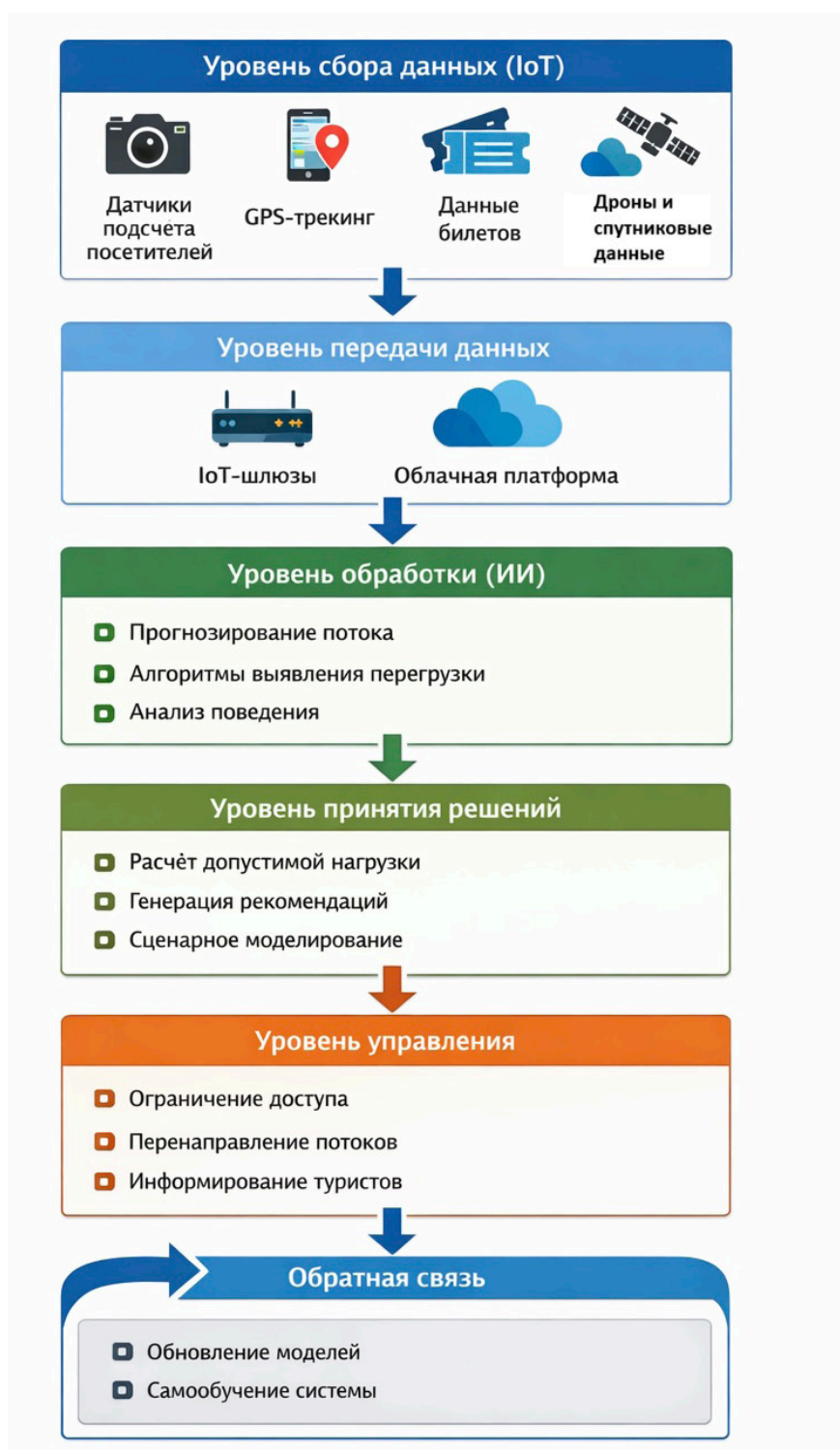
Рисунок 1. Архитектура системы интеллектуального мониторинга и управления туристскими потоками в ООПТ
